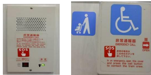
〈非常警報装置〉
