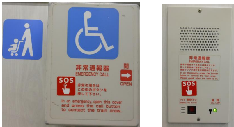
〈非常警報装置〉
